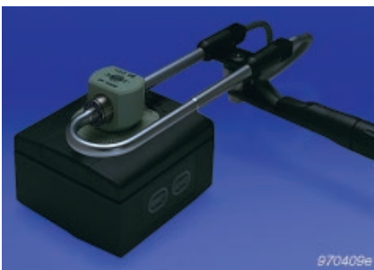
Abb. 6 Druck-Kalibrierung mit dem akustischen Kalibrator
